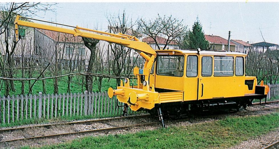
Les draisines de la série D 721 ont été conçues pour le service général de l'entretien de la voie et pour pouvoir circuler dans le cadre du graphique général de l'exploitation; de ce fait elles peuvent circuler à 60 Km/h et remorquer des charges variables suivant la vitesse désirée et le profil de voie.
